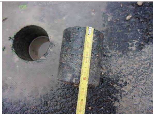
Photo n° 1B / prélèvement n° 1 Enrobé bitumineux routier Parking collaborateur, emplacement C1
