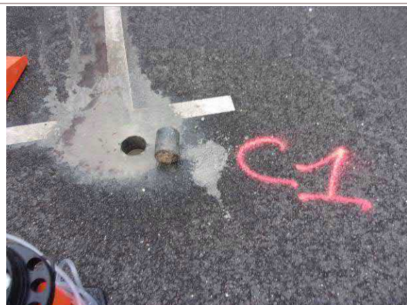
Photo n° 1A / prélèvement n° 1 Enrobé bitumineux routier Parking collaborateur, emplacement C1
