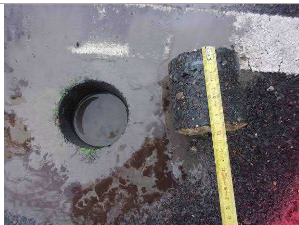
Photo n° 2B / prélèvement n° 2 Enrobé bitumineux routier Parking collaborateur, emplacement C2
