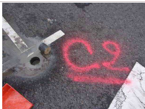
Photo n° 2A / prélèvement n° 2 Enrobé bitumineux routier Parking collaborateur, emplacement C2
